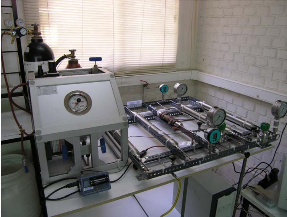
**Fig. 2.** Vista general del dispositivo experimental de permeación y la bomba de CO<sub>2</sub> líquido ( $P_{\text{max}} = 250 \text{ bar}$ ,  $T_{\text{max}} = 230^{\circ}\text{C}$ )
